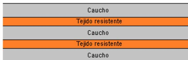
En general, es recomendable que el espesor de la lámina sea el mayor posible porque tiene varias ventajas; pero algunos constructores que trabajan con láminas de baja calidad también emplean láminas de elevados espesores. Por tanto, **el espesor de la lámina no siempre es un índice de la calidad del cuerpo de goma.**
