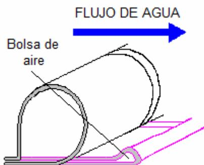
En la figura de la izquierda, se puede ver un esquema con la forma que adoptan las compuertas neumáticas para descansar sobre el lecho del río una vez desinfladas, con una bolsa de aire residual consecuencia del aire que queda retenido en su interior porque el desinflado no puede ser completo a causa de la rigidez de la lámina de goma.
